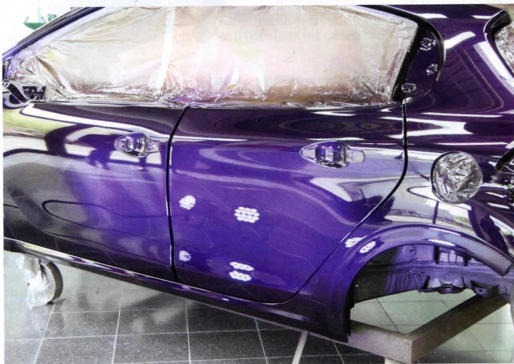
avec deux solutions : un brillant direct, qui associe la teinte et l'aspect brillant, ou une base mate qui contient les pigments de couleur, suivie d'un vernis. Le brillant direct est pulvérisé sur la surface à peindre sur une couche de 60 à 120 microns, la base mate est, elle, de 40 à 80 microns.
