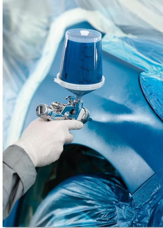
**Peintre** – Application de la peinture (base et vernis) et séchage du véhicule, en cabine, par infrarouge ou par Ultra Violet
