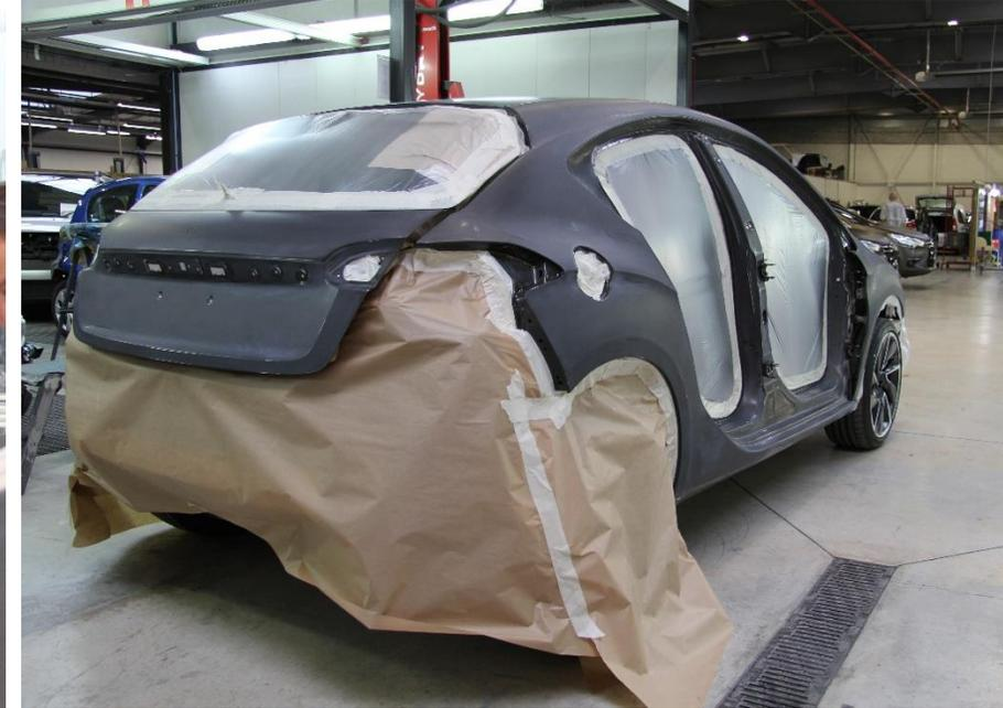
**Mécanicien, préparateur, carrossier, soudeur, tôlier** – Le véhicule passe successivement les étapes de sa remise en état : mécanique (contrôle des organes moteurs, freinage, sécurité, optiques), redressage, tôlerie, remise en état et lustrage de la carrosserie, rénovation des plastiques, préparation des surfaces à peindre
