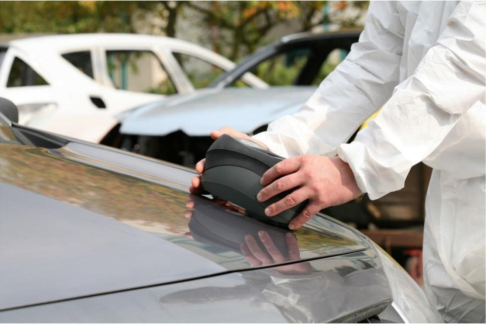
Formulation des teintes à l'aide d'un spectrophotomètre. Il calcule automatiquement et enregistre la formule qu'il envoie à la balance avec laquelle il est connecté
