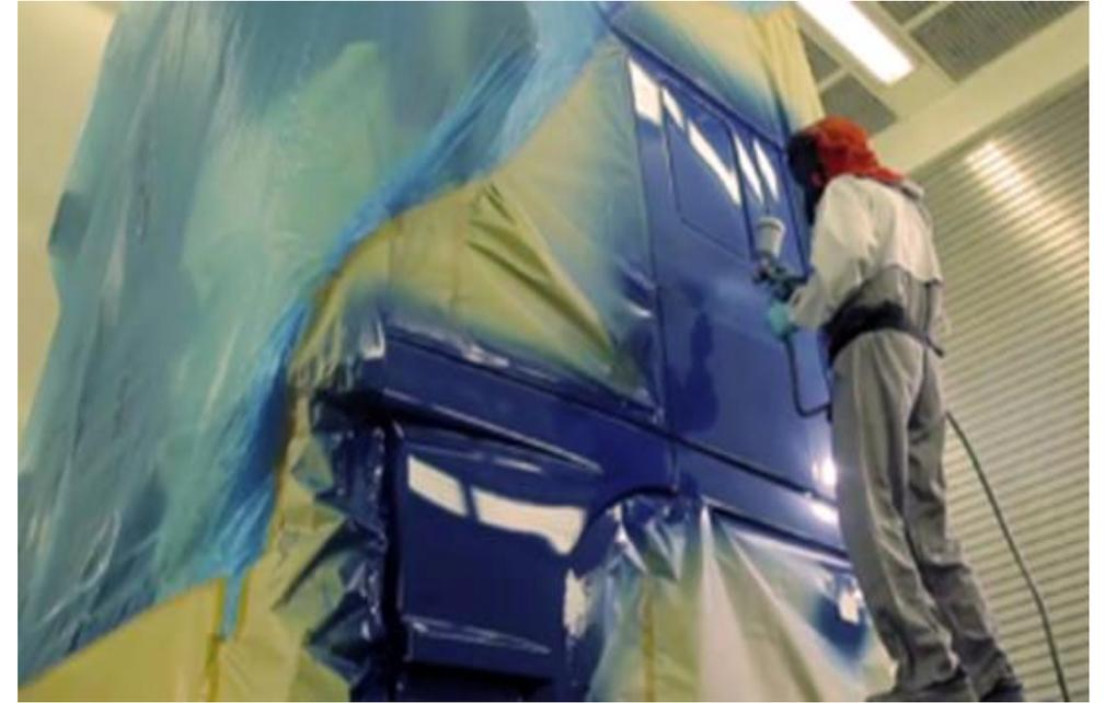
APPLICATION : Passer en cabine pour la mise en peinture (sous-couche + finition) puis le séchage du véhicule
