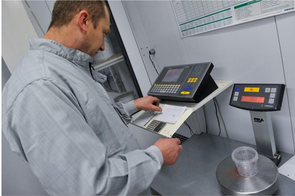
COLORIMETRIE > Identifier la teinte à l'aide d'un spectrophotomètre puis la préparer dans le laboratoire peinture
