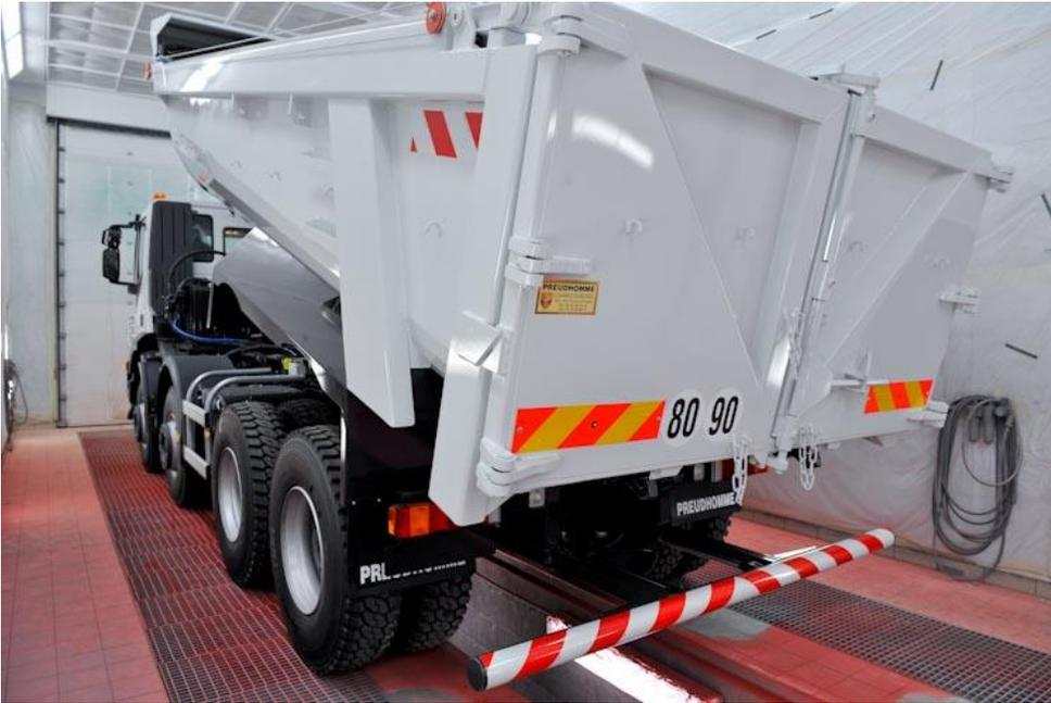
CONTROLE > Vérifier la qualité de la réparation qui doit être invisible : réparation et raccord des teintes entre les différents éléments de carrosserie
