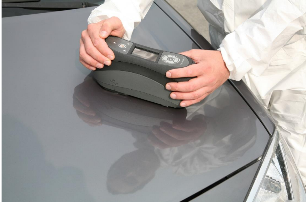
Identification de la teinte à l'aide d'un spectrophotomètre
