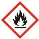
Dans l'atelier de réparation carrosserie, **les produits contenant des solvants sont inflammables**. Il convient de les manipuler avec précautions et de les employer à bon escient selon les recommandations des fabricants, stipulées sur l'étiquetage et les FDS (Fiche de données de Sécurité).
