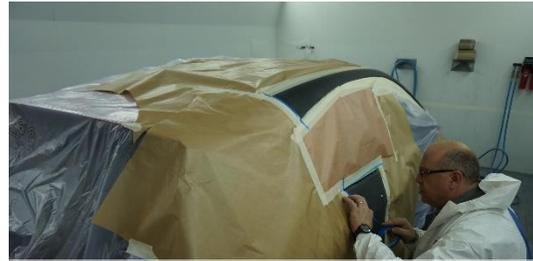
Préparation du véhicule. Selon les cas, la peinture peut être réalisée sur le véhicule complet ou un seul élément de carrosserie
