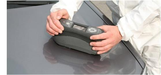
Identification de la teinte à l'aide d'un spectrophotomètre
